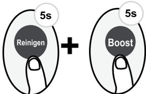
Drücken Sie die Reinigen-Taste und die Boost-Taste gleichzeitig länger als 5 Sekunden, um die Sperrfunktion zu aktivieren. Alle Tasten reagieren nur, wenn Sie diese beiden Tasten erneut zwei Sekunden lang drücken, um die Verriegelung zu deaktivieren.
